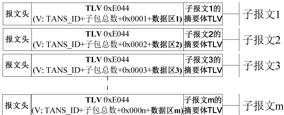
图1 M2M终端设备与M2M平台之间的协议报文报文的完全加密拆分示意图
