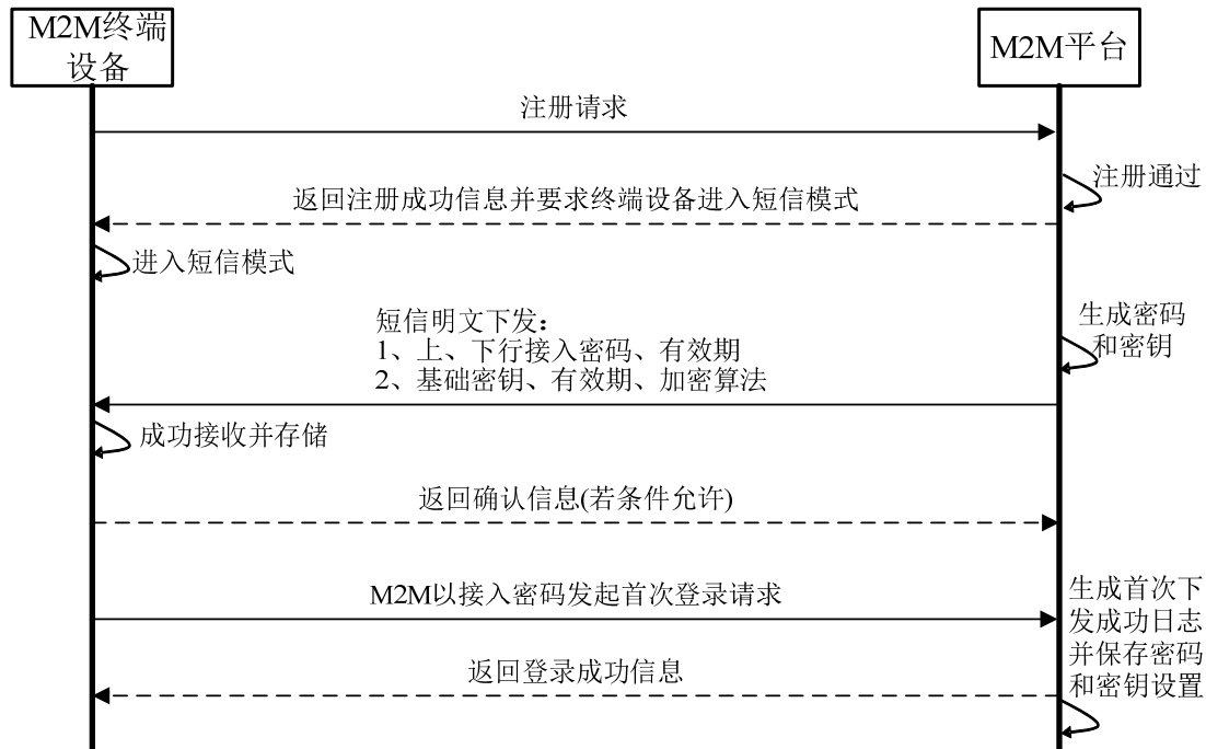
图 27 M2M终端设备首次获取其接入密码和基础密钥的流程
